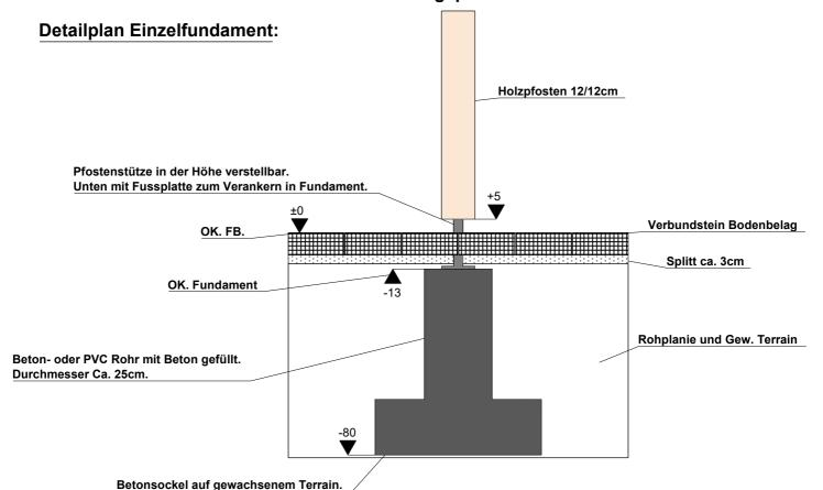
Bild eines Holzpfostens mit Höhenverstellbarem Pfostenfuss und Fussplatte.
